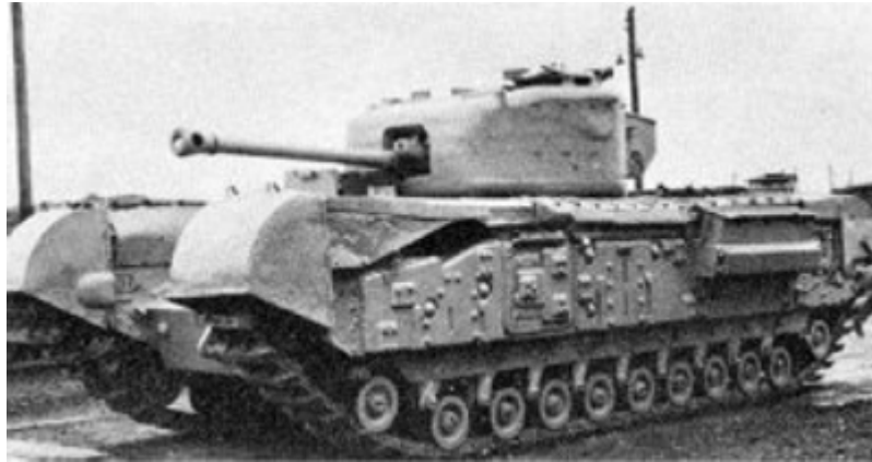
Figura 14-89. Tanque de infantería Churchill: Mk I con cañón de 2 Lb. Fuente: Biblioteca Alcar (1982)
