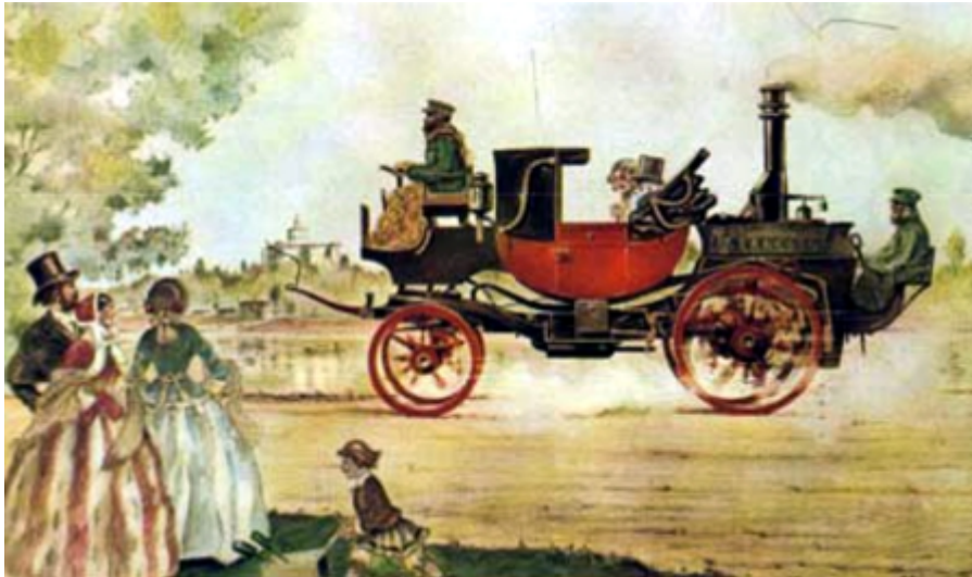
Figura 3-24. Vehículo a vapor de Virginio Bordini (Italia), pesaba unos 3000 kg y alcanzaba una velocidad de 8 km/h. Fuente: Pininfarina (1967)
