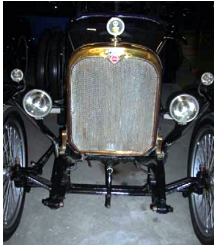
Figura 4-37. Sistemas de los primeros vehículos. Termómetro visible desde la cabina del conductor, mecanismo de arranque a manivela y sistema de suspensión consistente en muelles tipo ballestas. Foto: Agüero Alva, Hugo (2008).
