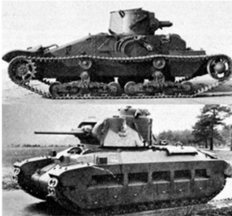
Figura 14-83. Matilda I (arriba), era un tanque literalmente pensado para la I Guerra mundial. El Matilda II (abajo) tenía blindaje frontal de 78 mm, virtualmente impenetrable para los cañones anticarro conocidos en 1940, y hasta la parte de las cadenas y la suspensión estaba cubierta con planchas de blindaje de 25 mm. Desarrollaba 24 km/h, autonomía de 250 km, cañón de 40 mm y dos ametralladoras de 7,9 y 7,7 mm. Fuente: Biblioteca Alcar (1982)
