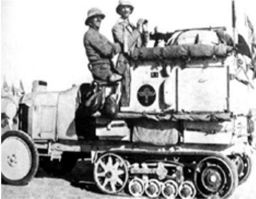
Figura 13-34. Camión semioruga fabricada por la francesa Citroën, que hizo la primera travesía motorizada exitosa a través del Sahara, en 1922.
