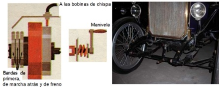
Figura 4-38 (Izquierda). Esquema de primeros mecanismos de arranque con manivela. Fuente: Rachlis, Eugene (1967). Figura 4-39 (Derecha). Mecanismo de arranque con manivela aplicado a uno de los primeros vehículos fabricados en el mundo. Foto: Agüero Alva, Hugo (2008)
