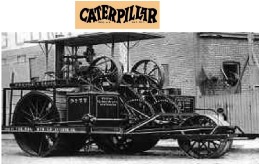
Figura 14-34. Primer Logotipo. Figura 14-35. Tanto Best como Holt construyeron grandes tractores a vapor que tenía un peso de unos 18.000 kg y potencias entre 40 y 110 CV. Estas moles usaban ruedas de tambores de hasta cinco metros de ancho.
