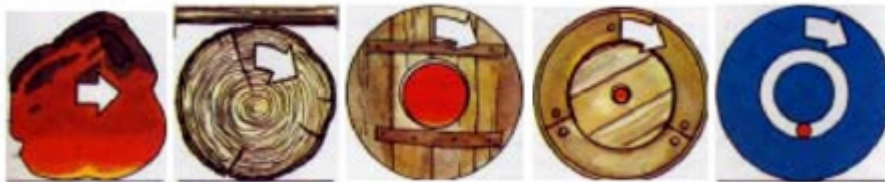
Figura 1-1. Evolución de la rueda para reducir el esfuerzo necesario para desplazar objetos pesados: de izquierda a derecha, el paso de la fricción al rodamiento, a continuación la rueda, en la que el rozamiento se produce en una zona reducida del eje; los sucesivos desarrollos han conducido a la reducción del rozamiento con ejes cada vez más pequeños y lubricados y a su total eliminación con el empleo de los cojinetes de rodamiento. Fuente: Enciclopedia Salvat del Automóvil (1974).
