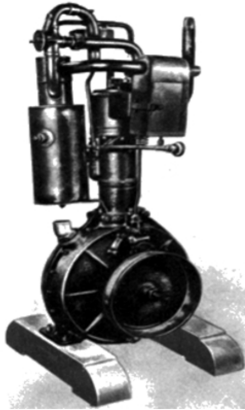
Figura 4-16. Motor monocilíndrico construido en 1885. Tenía 462 cc, 1,1 HP, encendido mediante un tubo de platino calentado por un calefactor externo. Se aplicó en el primer bicicleta Daimler. Fuente: Pininfarina (1967)
