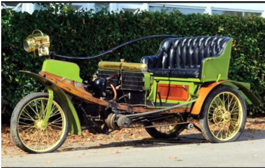
Figura 5-23. Triciclo Lacrolx De Laville de 1898, tenía un sistema de transmisión de correa de cuero en la rueda trasera izquierda. Fuente: Enciclopedia Salvat (1974).
