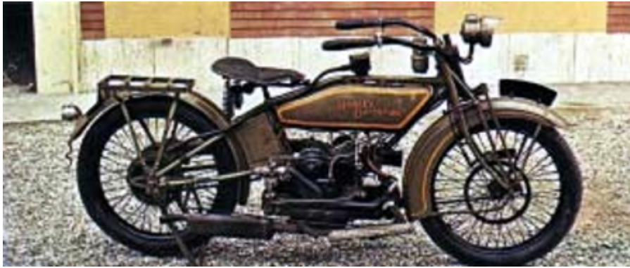
Figura 12-28. Sport Model de 1919. Motor de 584 cc con los cilindros horizontales y opuestos longitudinalmente. Alcanzaba una velocidad de 70 km/h.
