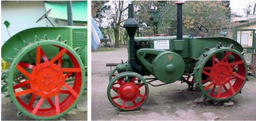
Figura 14-45. Derecha: Tractor "Lombardo", con motor a combustión interna. Izquierda: Detalle de la rueda de acero con reforzamiento en el sector de la banda de rodamiento.
