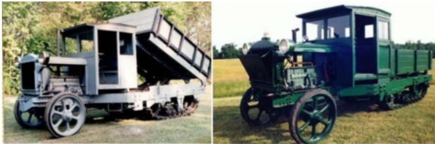
Figura 14-43. 1928, Tractor especial (volquete) “Lombardo”, fabricado por Alvin O. Lombard de Waterville USA. Tenía motor de 50 HP. Velocidad máxima: 7 a 8 mph. Peso: 8 Ton. Caja de transmisión: 5 adelante y una reversa. Figura 14-44. Tractor agrícola semioruga, para trabajos de campo.
