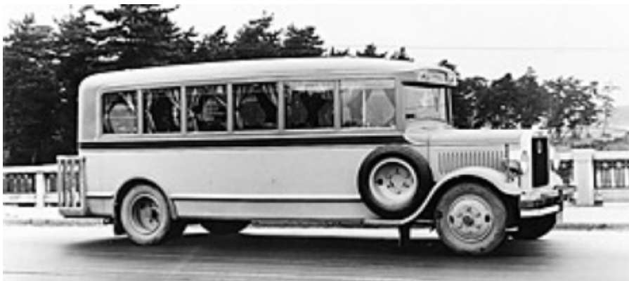
Figura 13-69. En 1932, Mitsubishi fabrica el "B46", que fue el primero de la serie FUSO. Este bus tenía 7m de longitud, motor a gasolina de 100 HP, capacidad de 38 pasajeros y desarrollaba una velocidad máxima de 70 km/h.
