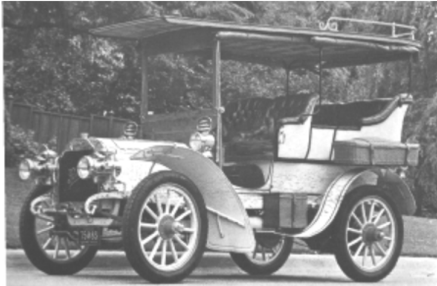
Figura 7-20. Primer modelo Peerless, fabricado en 1903, con motor de 4 cilindros y 3720 cc. Fuente: Enciclopedia Salvat (1974)
