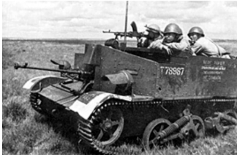
Figura 14-77. Tenía un motor Ford 8 en V de 85 HP. Era empleado como vehículo de reconocimiento. Velocidad máxima: 48 km/h, autonomía de 250 km, blindaje de 20 mm, armamento: y ametralladora Bren de 7,7 y mortero de 55 mm. Fuente: Biblioteca Alcar (1982)
