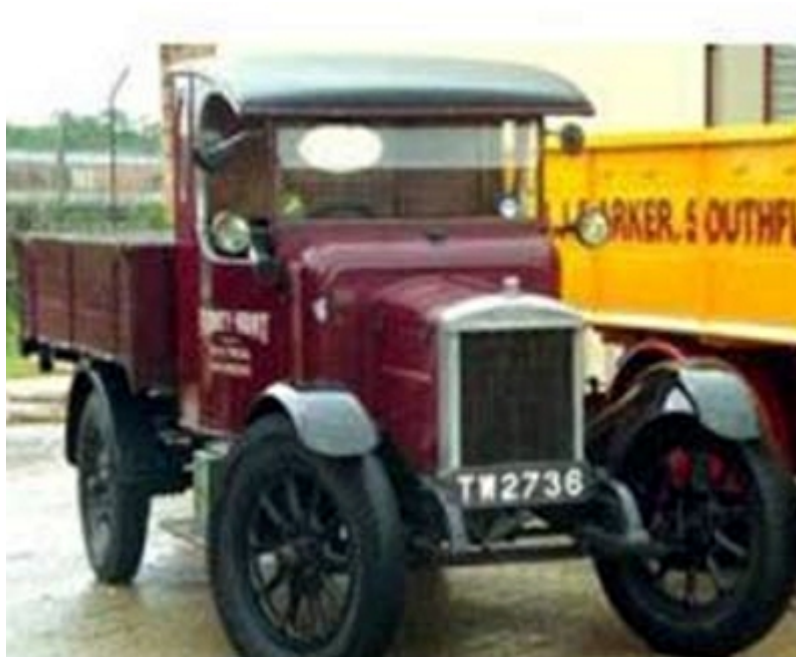
Figura 13-33. Camión de 1 tonelada fabricada por Morris modelo Dropside Lorry, construido en 1920
