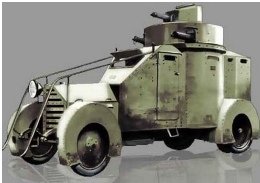
Figura 14-67. Vehículo blindado Lancia AZ, construido durante la PGM El primer intento de construcción de tanque
