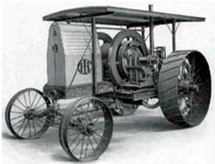
Figura 14-5. En 1906, International Harvester presenta su primer tractor, sobre la plataforma de la caja del camión S.S. Mortons motorizado con motor monocilíndrico International, disponible con potencias de 10, 12 15 y 20 CV.
