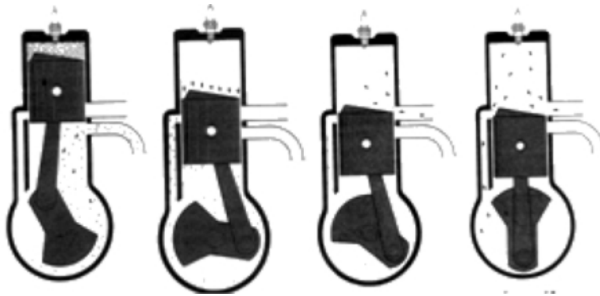
Figura 4-3. De izquierda a derecha: 1) Compresión en la cámara y admisión en el carter. 2) Expansión en la cámara y precompresión en el carter. 3) Escape en la cámara y compresión en el carter. 4) Paso de gases del carter a la cámara
