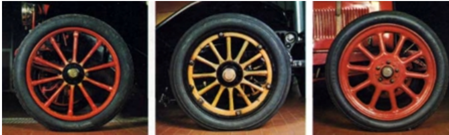
Figura 11-3. Diferentes tipos de ruedas. Izquierda: Rueda de madera con refuerzos metálicos (1900). Centro: Rueda de madera con garganta desmontable (1900). Derecha: Rueda totalmente metálica (1927).
