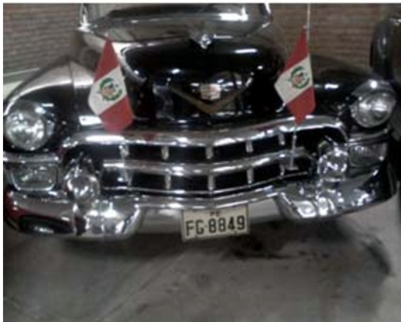
Figura 15-21. Marca: Cadillac Modelo: Fleetwood Tipo: Presidencial Año: 1953. Fabricante: Cadillac Motor Co. EEUU Motor: 8 en V, 210 HP Velocidad: 160 km/h Foto: Agüero Alva, Hugo (2008)
