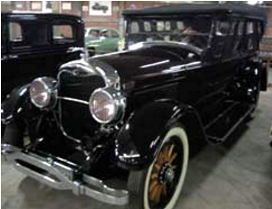
Figura 15-14. Marca: Lincoln. Modelo: L Tipo: Phaeton by Brunn. Año: 1925 Fabricante: Lincoln Motor Company. EEUU Motor: 8 en V, 90 HP a 2800 rpm Velocidad: 120 km/h. Primer automóvil de la colección, vino de Arequipa y en Lima hacía servicio de colectivo entre la Plaza Unión y Carmen de la Legua en el Callao. Foto: Agüero Alva, Hugo
