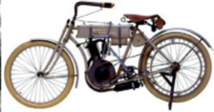
Figura 12-26. Davidson con su primera motocicleta. Figura 12-27. Primera motocicleta fabricada por HD, monocilíndrico, 160 cc y 3 HP, fabricada en 1903
