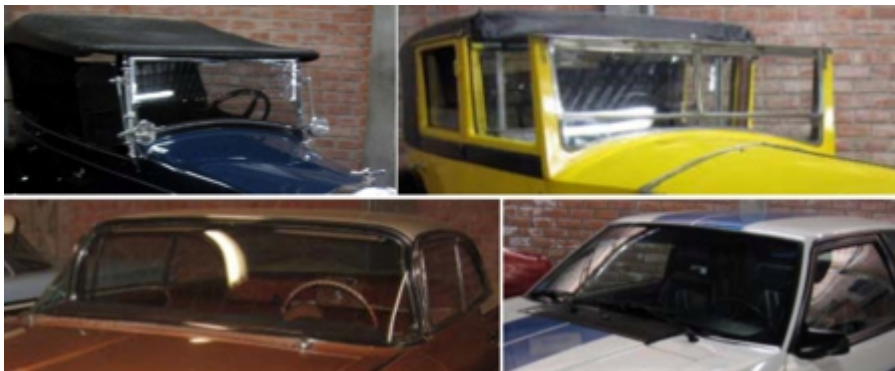
Figura 5-45. Los parabrisas son elementos ligados a la seguridad, tuvieron un desarrollo desde vidrios planos seccionados o articulados en su parte superior, hasta curvos y panorámicos. Fuente: Enciclopedia Salvat del Automóvil (1974)
