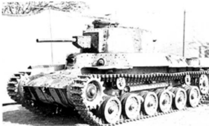
Figura 14-80. Producido por Mitsubishi en 1937. Tenía un motor diesel Mitsubishi Type 97 de 170 CV, refrigerado por aire. Su velocidad era 38 km/hora, su radio de acción era 210 km en carretera y 90 km en tierra. Armamento: cañón de 57 mm y 2 ametralladoras de 7.7 mm. Fuente: Biblioteca Alcar (1982)
