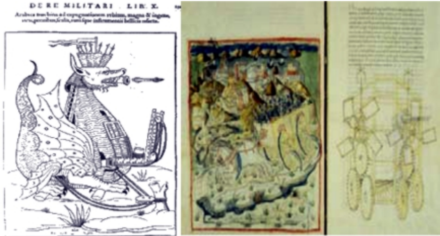
Figura 2-5. Dibujos de Valturlo. En la derecha se aprecia una especie de vehículo con ingeniosos mecanismos de transmisión un tanto complicados. Eran movidos por la fuerza muscular.
