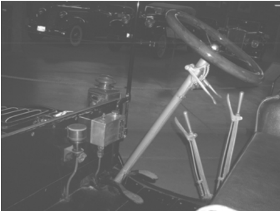
Figura 5-27. Palancas de frenos delantero y posterior de mano ubicadas al lado del conductor. Fotografía: Autor
