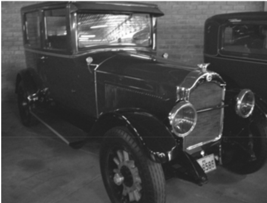
Figura 7-28. Automóvil Studebaker Modelo Special S1x, Tipo: Tudor Coupe 1924. Tiene un motor de 6 cilindros en línea, 4729 cc, 50 HP a 2000 RPM, desarrolla una velocidad de 80 km/h. Foto: Autor
