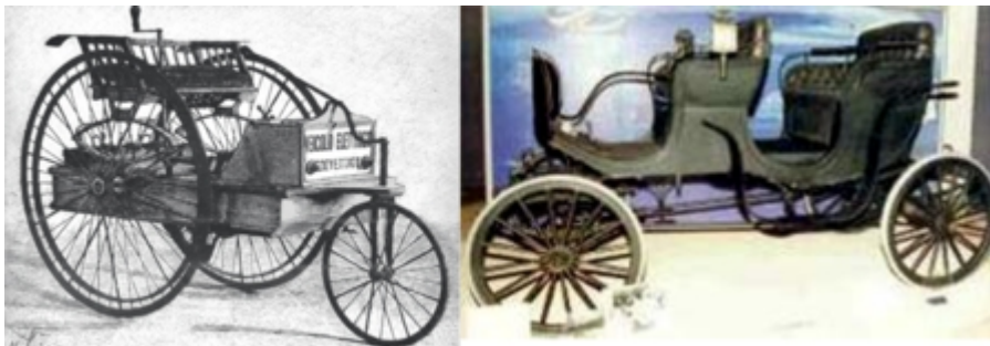
Figura 9-11. En 1895, Giuseppe Carli (Italia), construye un vehículo eléctrico equipado por acumuladores tipo Verdier. Cada uno de ellos de diez elementos de 100 amperios-hora de capacidad que le daba una autonomía de cuatro a cinco horas. Fuente: Pininfarina 1/8.
