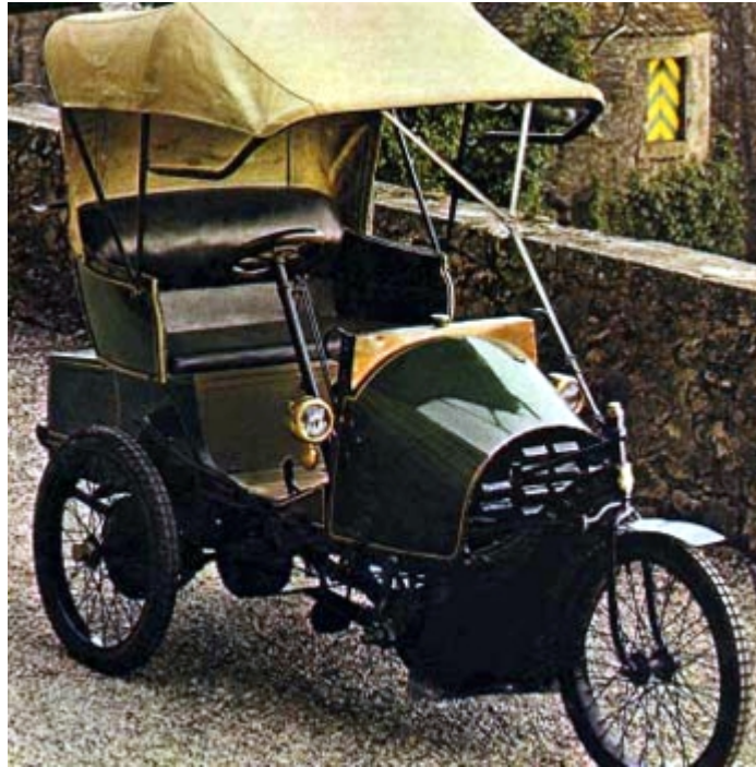
Figura 5-35. Vehículo con motor delantero, seguía manteniendo techo con toldo removible. Fuente: Enciclopedia Salvat (1974)
