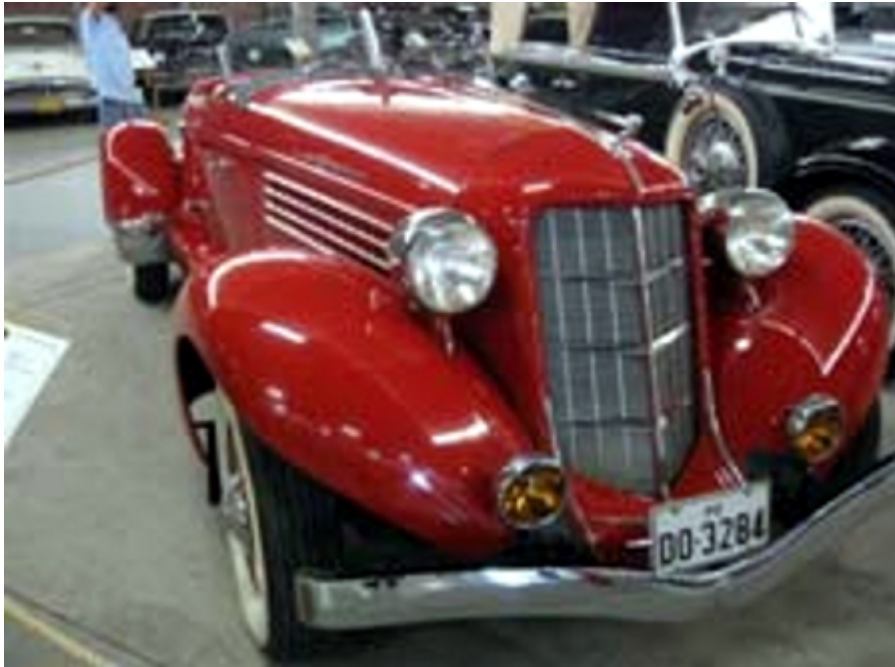
Figura 15-20. Marca: Auburn. Modelo: Speedster 851SC. Año: 1935. Fabricante: Auburn Automobile Co. EEUU. Motor: 8 en línea, 150 HP. Velocidad: 160 km/h. Se le considera como el último gran automóvil deportivo americano de los años 30. Batió todos los records de velocidad en 1935. Foto: Agüero Alva, Hugo (2008)
