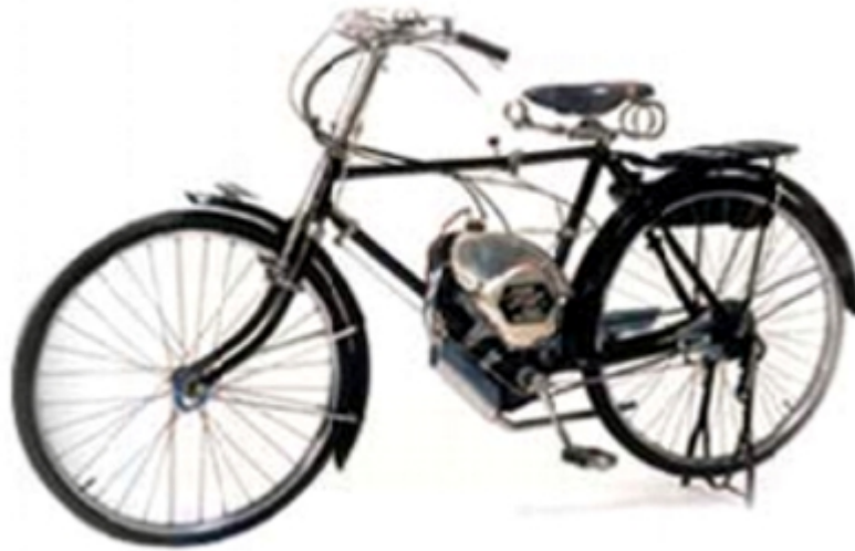
Figura 12-45. Power Free, primera motocicleta fabricada por Suzuki en 1952. Tenía 36 cc.
