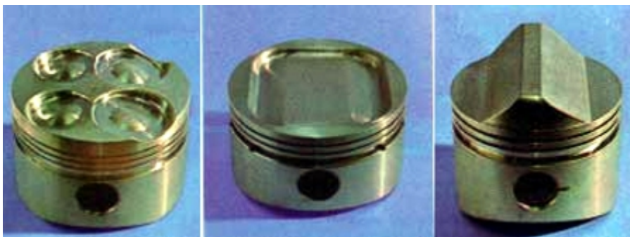
Figura 4-30. Pistón del motor Ferrari 312 B de 4 válvulas; pistón de cabeza plana con una sola concavidad para las 4 válvulas del Lancia
