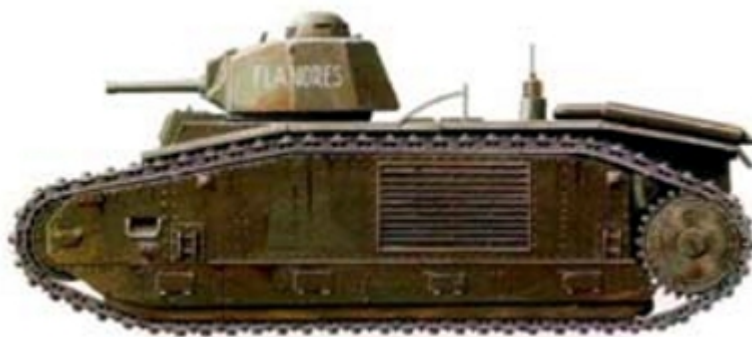
Figura 14-81. Producido entre 1939 y 1940. Pesaba 31 toneladas, tenía un motor Renault de 300 HP, desarrollaba un velocidad máxima de 29 km/k, autonomía de 200 km, cañón de 75 mm, blindaje de 60 mm. Torreta fija, por lo que para apuntar se necesitaba mover todo el tanque. Fuente: Biblioteca Alcar (1982)
