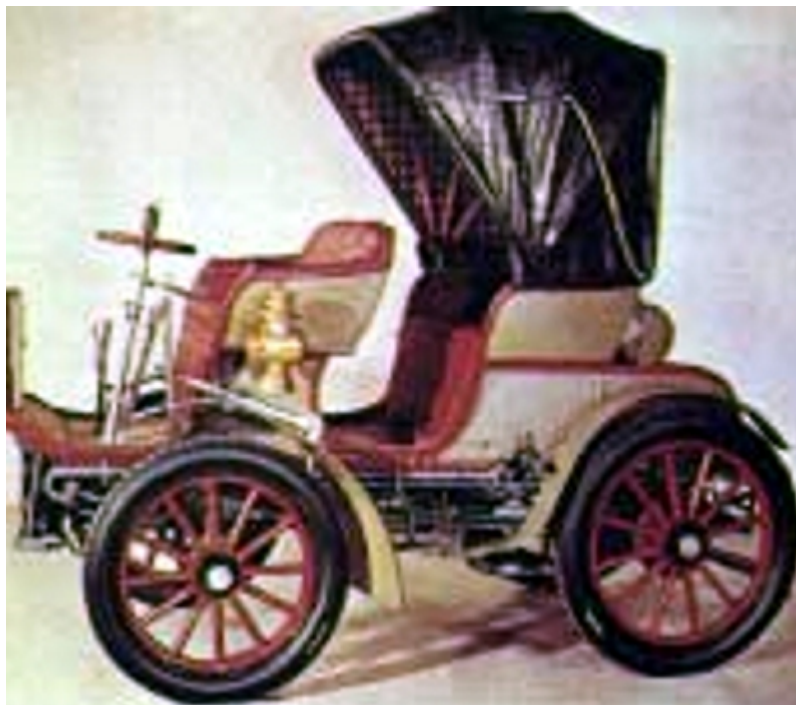
Figura 6-23. Un Weber de 1903, con motor monocilíndrico delantero refrigerado por aire y transmisión por eje articulado. Es característico el volante redondo pero dotado de 2 mangos verticales. Fuente: Enciclopedia Salvat del Automóvil (1967)
