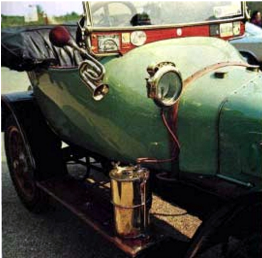
Figura 5-44. Faro con gas de acetileno y bocina de un Delage 1911.
