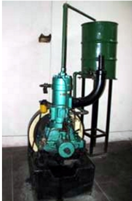
Figura 15-8. Modelo: prototipo peruano, del Ing. Grleve (1930). Número de cilindros: 1 cilindro. Refrigeración: por líquido, termosifón. Velocidad: 400 rpm. Diámetro x carrera: 108,2 x 230 mm Relación de compresión: 18,65 a 1 Presión de inyección: 160 bar. Este motor se conserva en el Instituto de Motores de la Universidad de Ingeniería de Lima. Foto: Agüero Alva, Hugo
