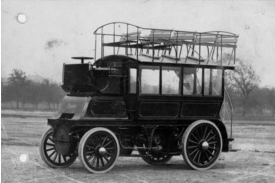
Figura 13-56. En 1898, Daimler, fabrica el primer ómnibus para el transporte de pasajeros. Fueron fabricados cuatro diferentes modelos para 6 y 16 pasajeros, con motor de 4 a 10 HP. Fue el primero en fabricar una serie completa de buses motorizadas.
