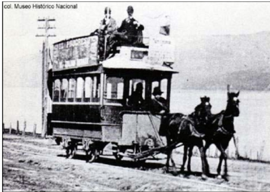
Figura 1-16. 1886. El Ferrocarril Urbano de Concepción (Santiago) inauguró un tranvía a tracción animal, con carros de dos pisos contruidos por John Stephenson en Nueva York
