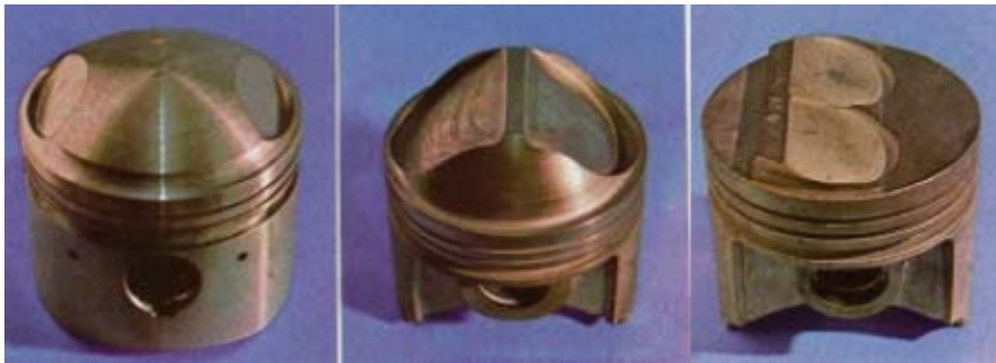
Figura 4-29. Pistón bombeado (cabeza convexa) del Alfa Romeo 2000; pistón preparado para el mismo coche (obsérvese el notable abombamiento y la aligeración realizada en los flancos), y pistón preparado para el Fiat 500, dotado de deflector y de concavidades para las válvulas inclinadas y paralelas. Fuente: Enciclopedia Salvat (1974).
