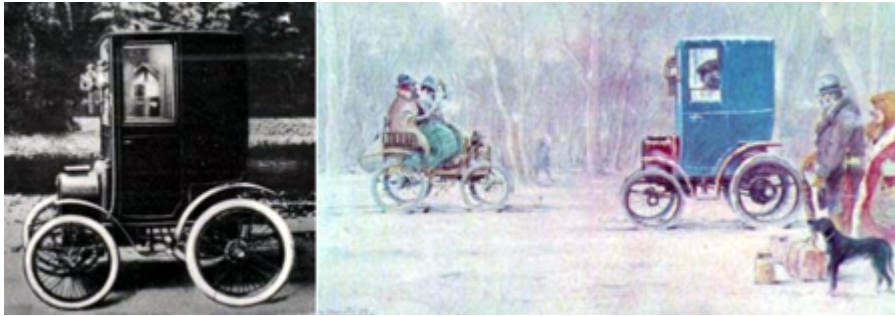
Figura 5-36. Izquierda: Primer automóvil del mundo con cabina, donde el chofer se encontraba en la parte Interna del vehículo. Fue construida por los hermanos Renault. Derecha: un grabado de la época, el mismo automóvil Renault y otro sin carrocería, soportando las inclemencias del tiempo. Fuente: Pininfarina (1967)
