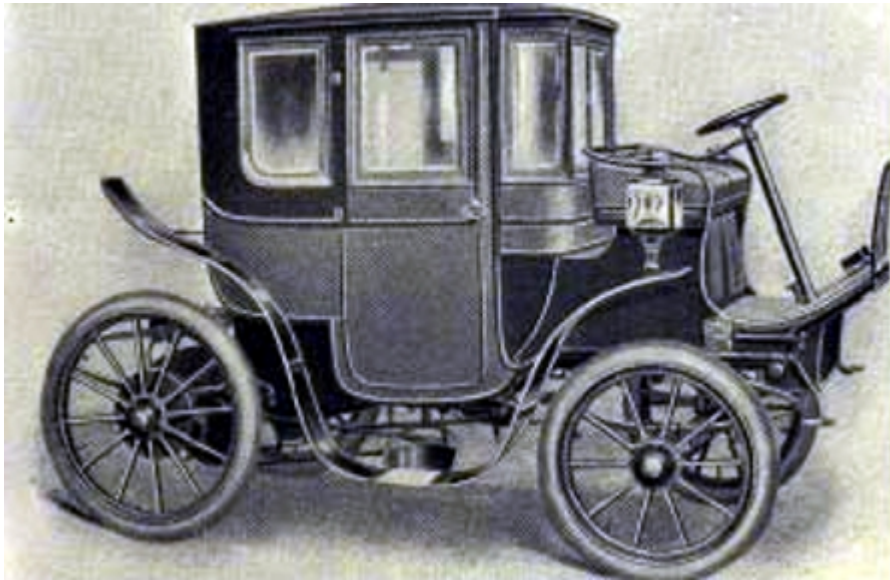
Figura 9-19. El Ausonia de 1906, con propulsión eléctrica. Disponía de dos motores de 5 CV colocados cerca de las ruedas traseras.
