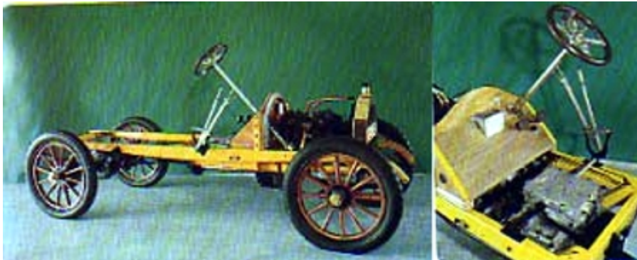
Figura 5-19. Izquierda: Chasis de Ceirano Itala 24 HP de 1904. Derecha: Volante, pedales y el cambio. Se observan los primitivos sistemas que componían el vehículo. Motor delantero, frenos accionados por palanca desde la cabina del conductor, columna de dirección rígida, largueros, etc. Fuente: Enciclopedia Salvat (1974)
