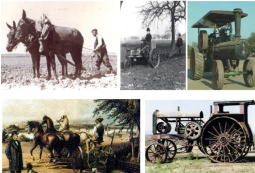
Figura 14-1. Las máquinas agrícolas pasaron de la propulsión, que le proporcionaba el hombre, caballo o bueyes a motores a vapor, luego a motores de combustión interna.
