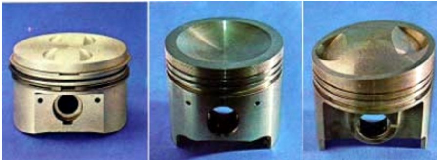
Figura 4-28. Formas más comunes para la cabeza del pistón. De Izquierda a derecha: pistón de cabeza plana (Fiat 130) con concavidades laterales para las válvulas (para permitir el montaje en ambos sentidos); pistón con cabeza rebajada (cóncavo), del Alfasud, y pistón con cabeza inclinada y ligeramente bombeada, del Lancia Fulvia 1600 (motor en V estrecha). Fuente: Enciclopedia Salvat (1974).
