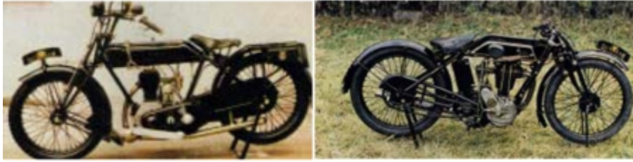
Figura 12-39. Izquierda: Una de las versiones de las motos Sunbeam de 3,5 CV de 1921. Derecha: Sunbeam de los años 20, distribución por varillas y balancines, con válvulas en la cabeza.
