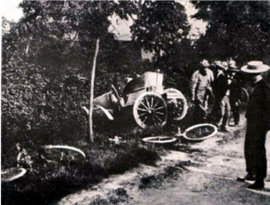
Figura 10-22. Accidente sufrido por Jenatzy durante la Vuelta a Francia, en 1899 sobre 2350 km. Al desbandarse una cubierta el auto se salió del camino y quedó semidestruido dentro de una zanja. El corredor resultó ileso.
