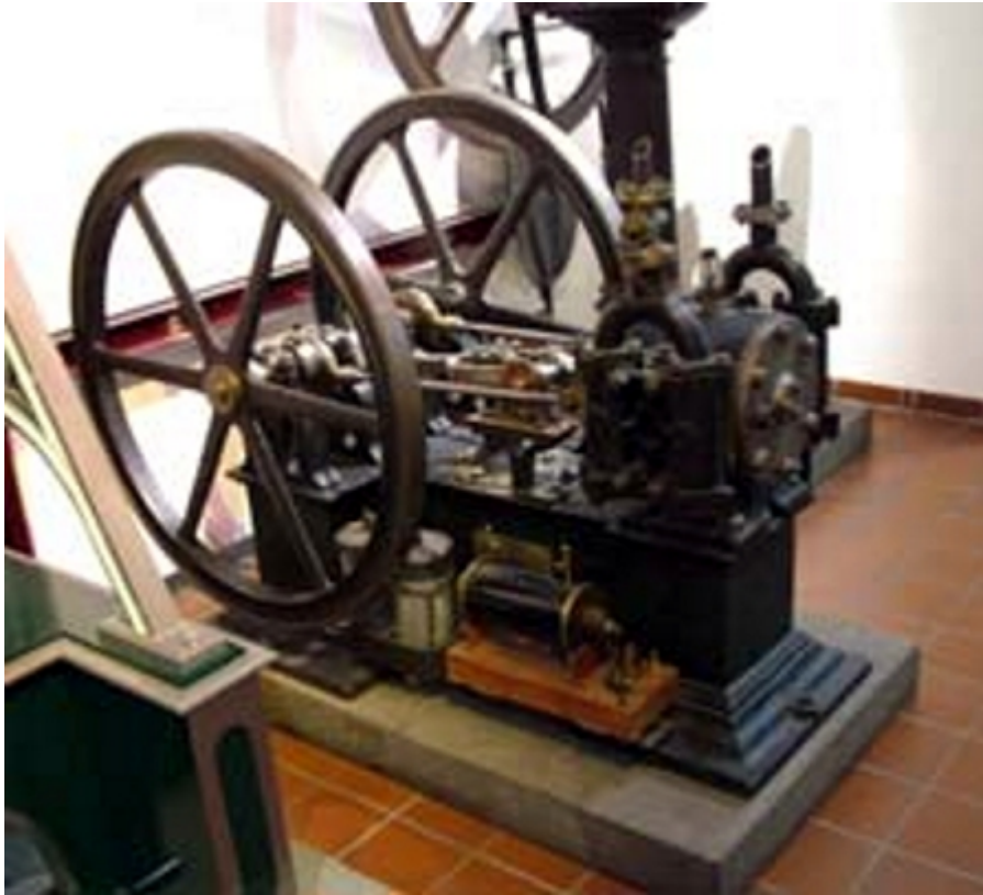
Figura 4-7. Motor de combustión interna de Lenoir. Potencia: 0,7 kW, 80 rpm. Un cilindro y enfriado por agua. Fuente: Pininfarina (1967)
