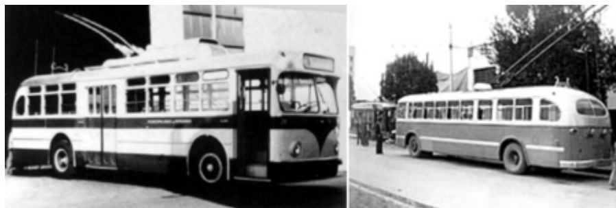
Figura 9-28. Un trolebús FIAT- Italia. Capacidad: 43 pasajeros sentados y 52 pasajeros de pie. Motor Marelli – CGE. Potencia 110 kw (150 HP). Frenos Eléctricos. Radio de giro: 18,6 m. Peso Vacío: 9900
