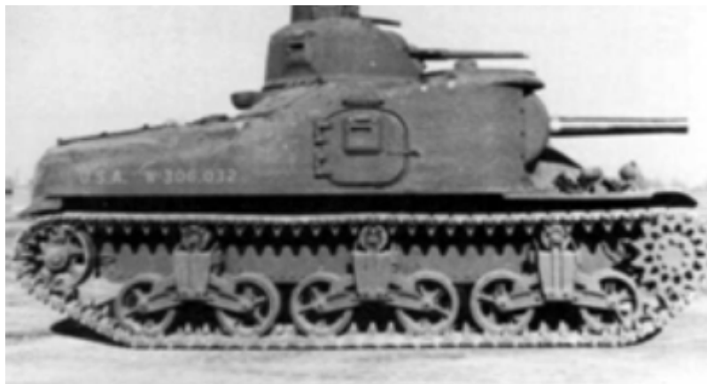
Figura 14-85. Fue diseñado y construido entre guerras. Cuando iba a entrar en combate en la SGM, lo declararon tecnológicamente obsoleto. Peso: 23,9 Tm, Longitud: 6,12 m, Anchura 2,72 m, Altura 3,12 m Altura sobre el suelo 43 cm. Fuente: Biblioteca Alcar (1982).
