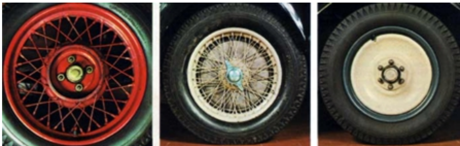
Figura 11-4. Diferentes tipos de ruedas. Izquierda: Rueda de radios con fijación Riley (1910-1930). Centro: Rueda de radios Rudge-Whitworth (1930-1960). Derecha: Rueda de disco con chapa (1925).
